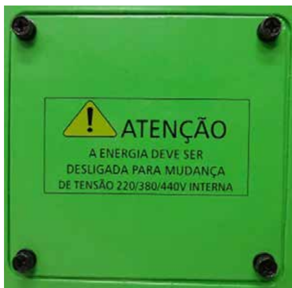
Figura 6.5: Compartimento para a mudança de tensão
