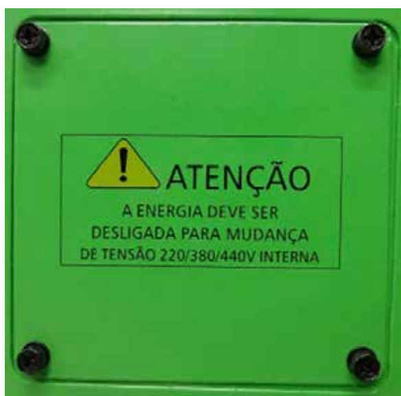
Figura 6.1: Compartimento para a mudança de tensão
