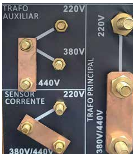
Figura 6.4: Fechamento para 440 V
