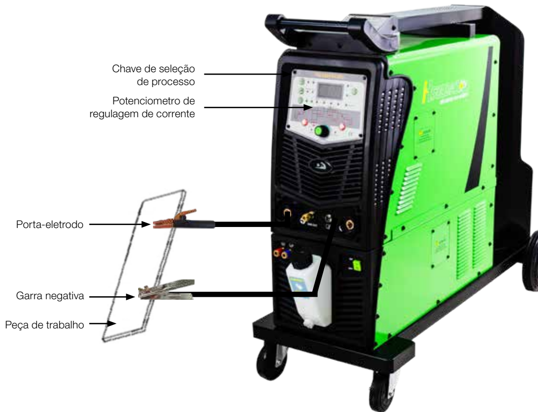
Figura 8.3: Processo de solda eletrodo revestido
