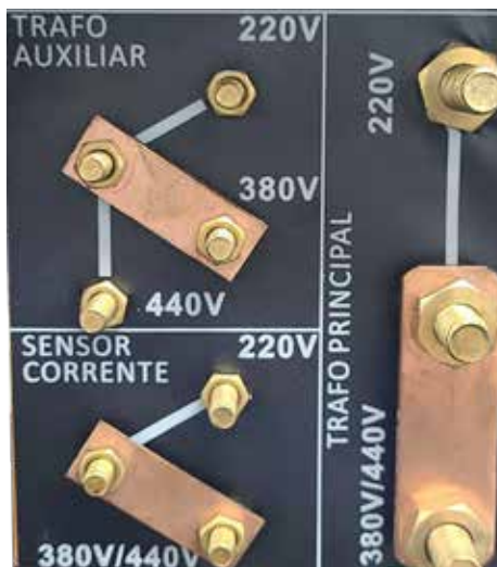
Figura 6.3: Fechamento para 380 V
