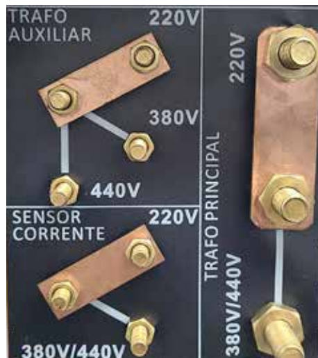
Figura 6.2: Fechamento para 220 V
