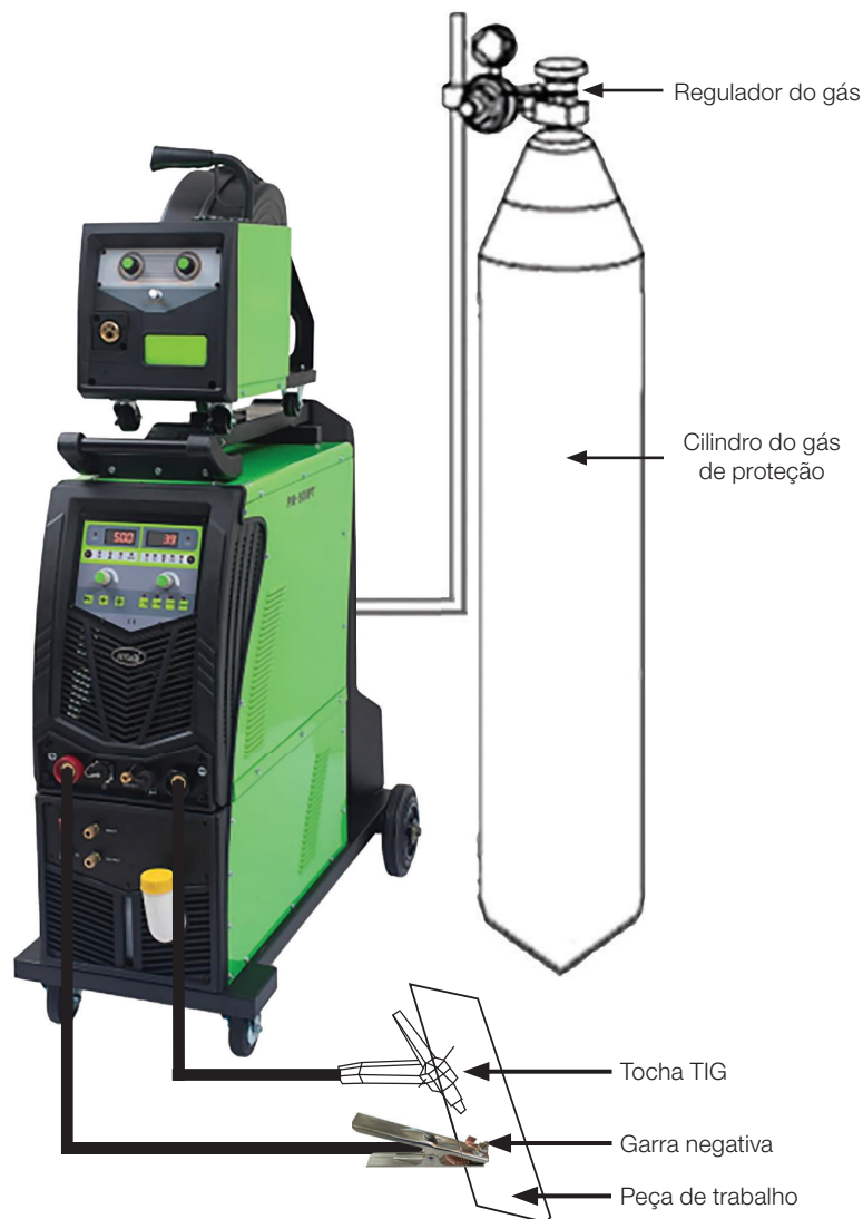
Figura 7.2: Ligação dos cabos
