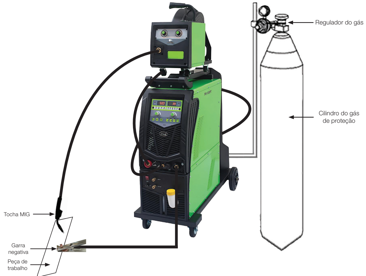
Figura 7.3: Ligação dos cabos
