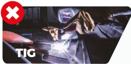
Exige profissionais altamente treinados, um processo de difícil execução e baixa eficiência. Alto índice de desperdício de material de adição e os materiais soldados exigem cuidado prévio com limpeza e preparação das juntas e chanfros, de modo a garantir a penetração necessária. Limitado aos ângulos de acesso na região a ser soldada.
